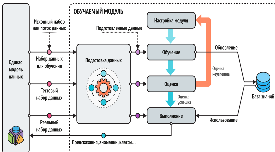
Рисунок 3 – Технология машинного обучения в управлении технологическим процессом производства
