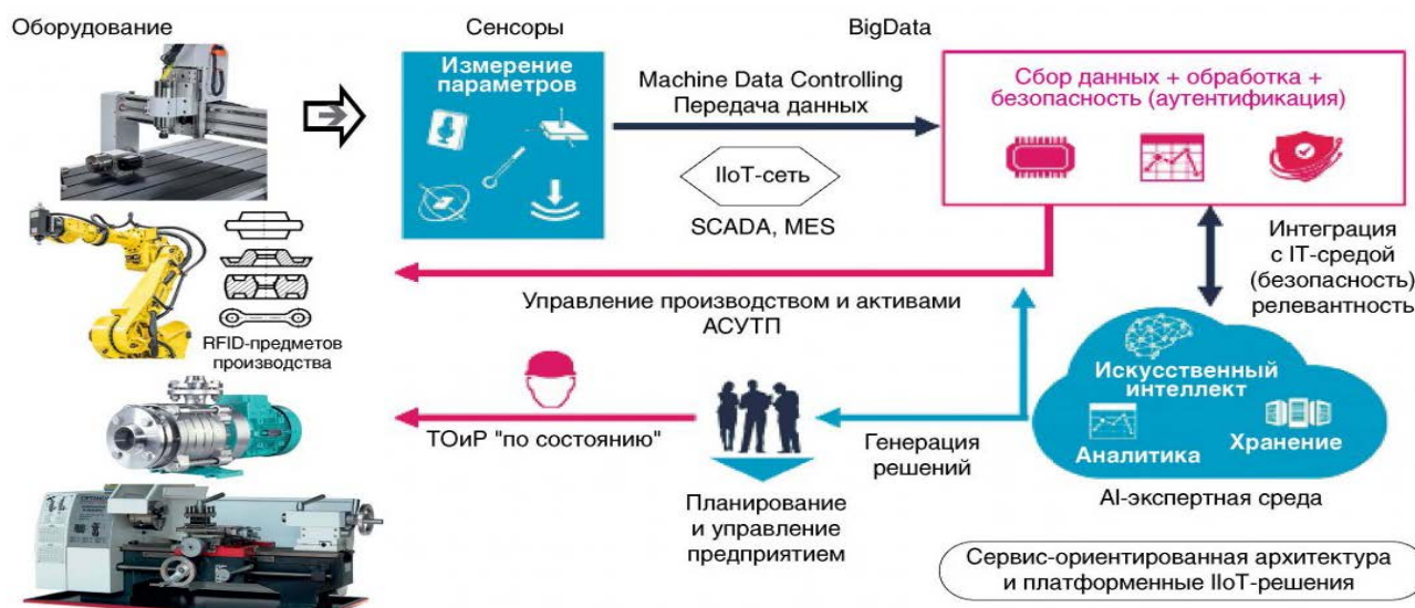
Рисунок 6 – Киберфизические системы и промышленный интернет вещей в хлебопекарном производстве
