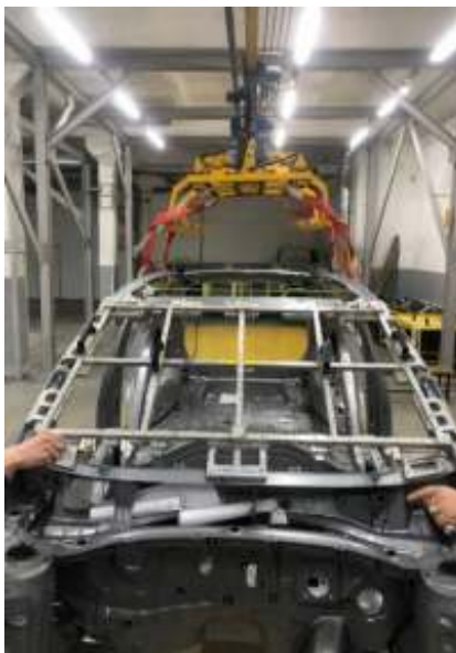
Рисунок 2 – Позиционирование замераемого элемента по принципу лучшего совмещения
