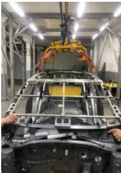
Рисунок 2 – Позиционирование замеряемого элемента по принципу лучшего совмещения
