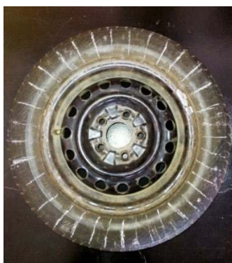
Рисунок 2 – Движитель R14 легкового автомобиля с нанесенными метками
