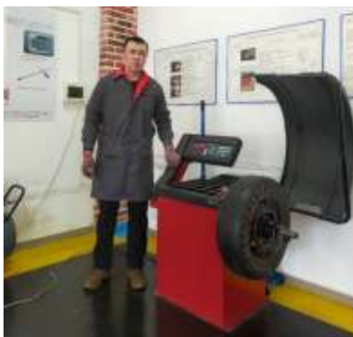
Рисунок 4 – Процесс окончательной балансировки двигателя R14 легкового автомобиля
