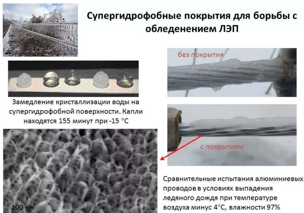
Рисунок 3 – Результаты экспериментов с применением адгезионного покрытия с супергидрофобными свойствами
